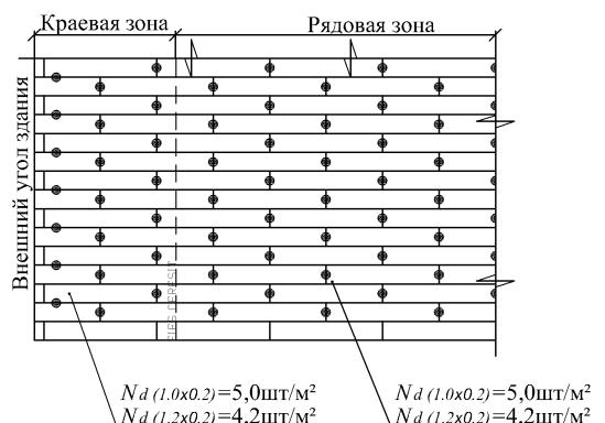
1. Ширина краевой зоны составляет  $1 \text{ м} \leq a/8 \leq 2 \text{ м}$ , где  $a$  — ширина торца здания.
