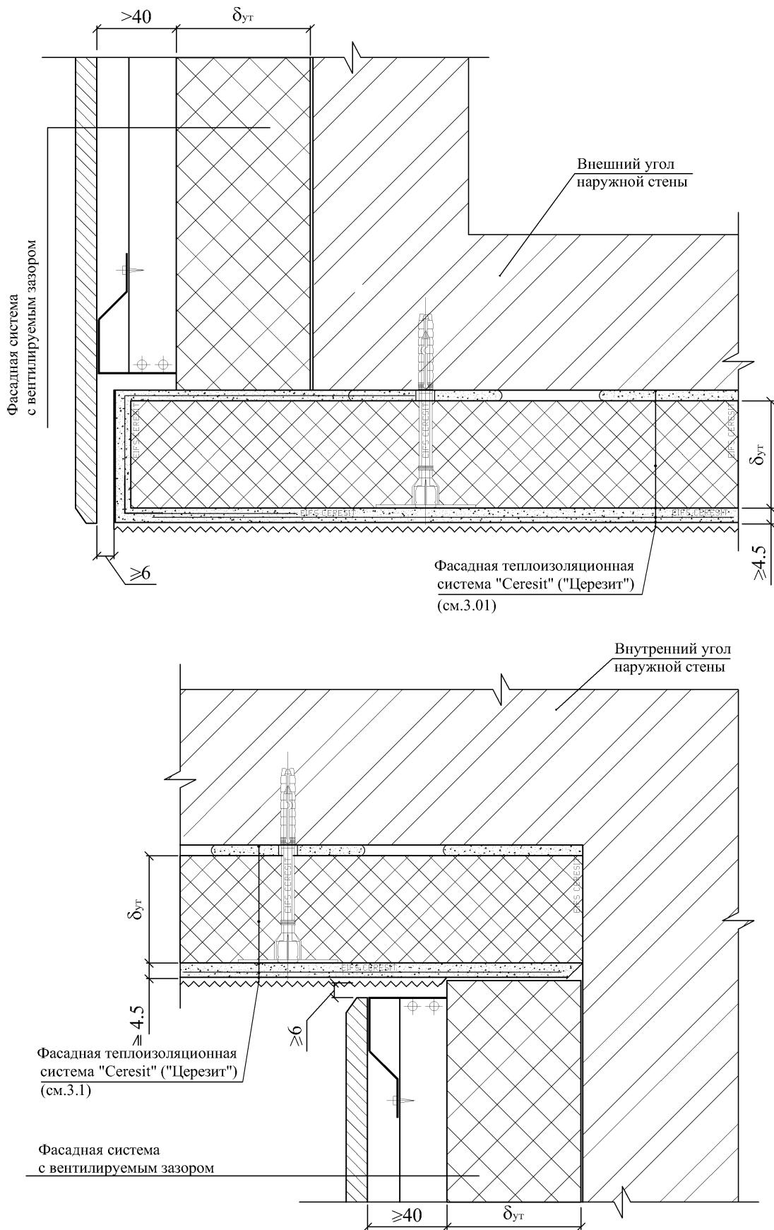
**A.3.8 Установка навесных элементов фасада (вывески, кронштейны, маркизы) на энергосберегающие анкеры с терморазрывом**
