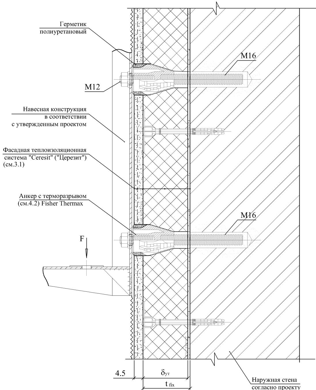
1. Допустимые нагрузки [кН] уточняются в проекте согласно расчету несущей способности элемента крепления и схемы установки анкеров, но не должны превышать следующих пороговых значений из расчета на один анкер [ $V_{zul}$ ] с учетом плеча прилагаемой нагрузки:
