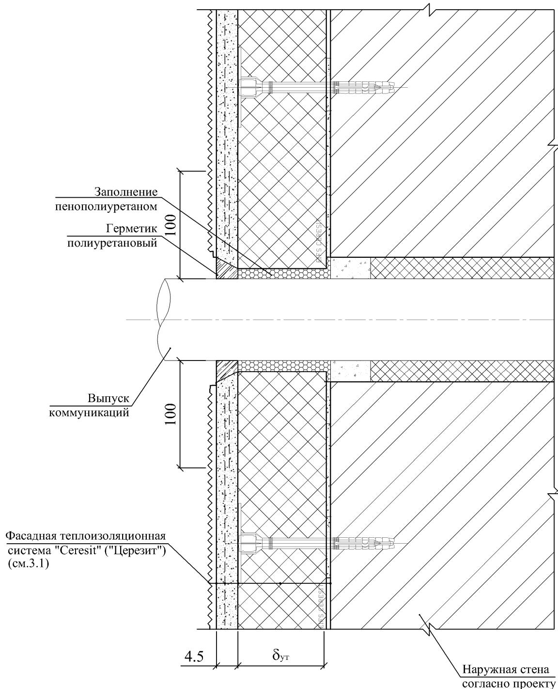
**П р и м е ч а н и е —** В зоне примыкания закладной детали в системе с теплоизоляцией из фасадного пенополистирола выполнить противопожарную рассечку шириной не менее 150 мм из негорючих материалов.
