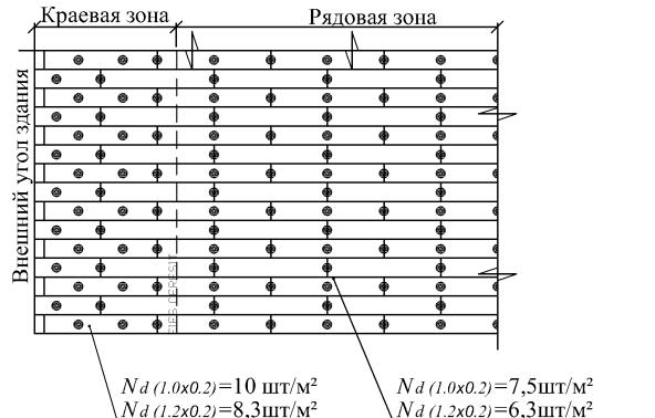
*Фрагмент теплоизоляции стен до отм. + 40,0 от уровня отмостки здания*
