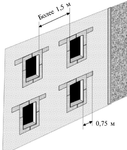
**Схема 7.2 — Размещение противопожарных рассечек вокруг проемов и в зоне примыкания**
