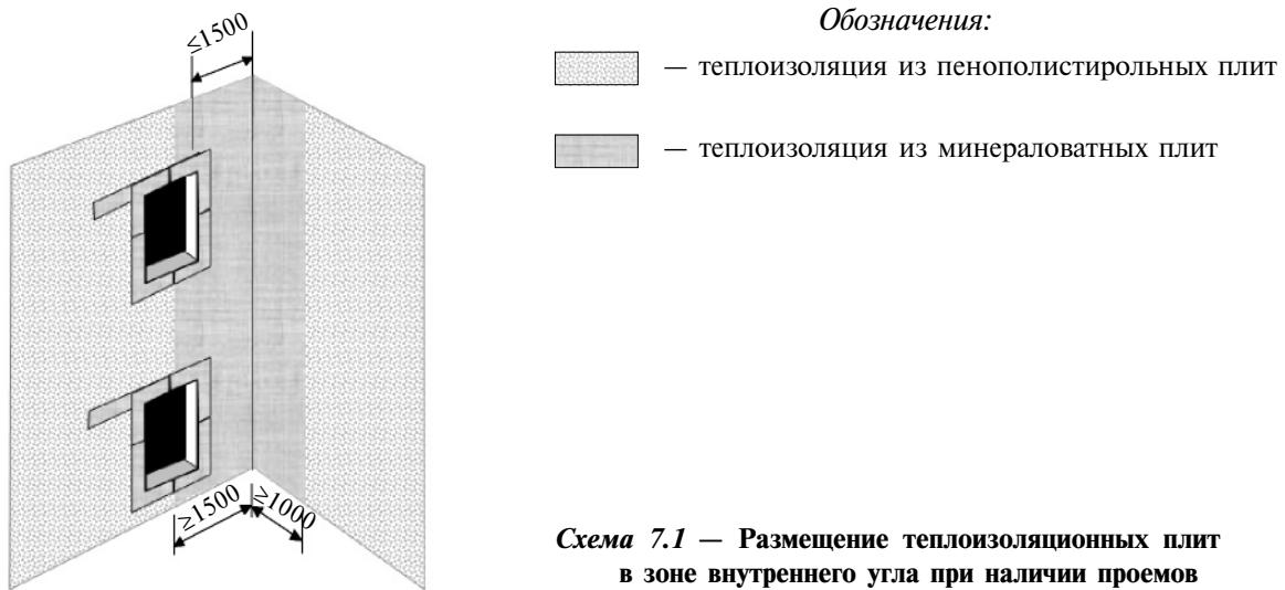
**Схема 7.1 – Размещение теплоизоляционных плит
