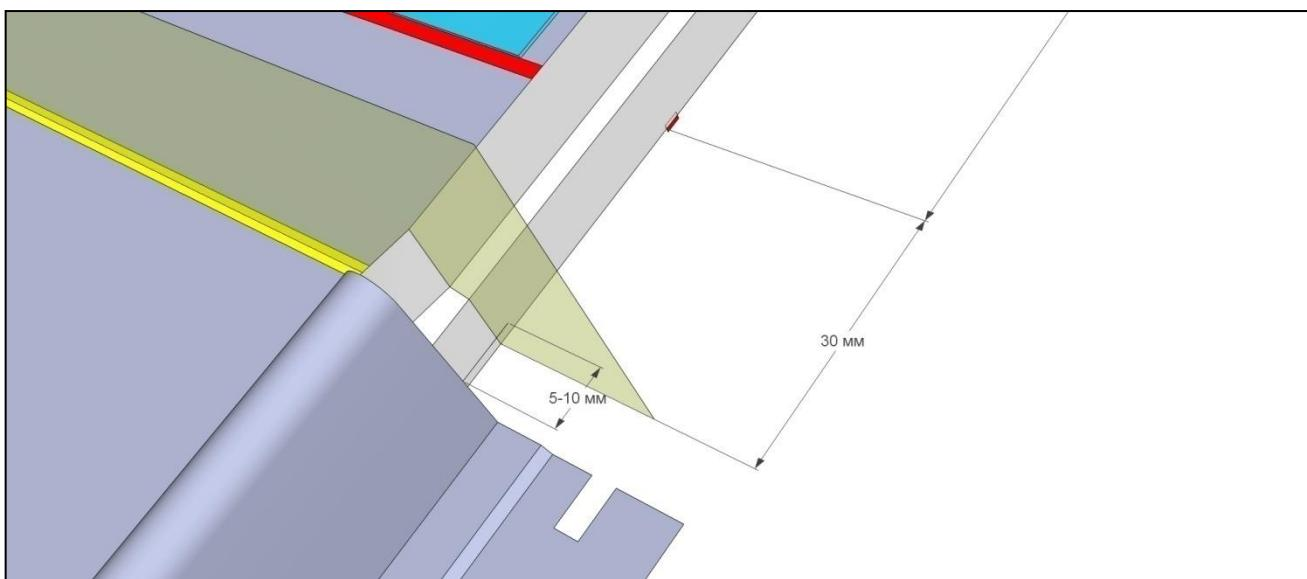
На накрываемой стороне полный нахлест гребней не нужен, поскольку в дальнейшем это место будет нарыто накрывающим гребнем следующей панели.
