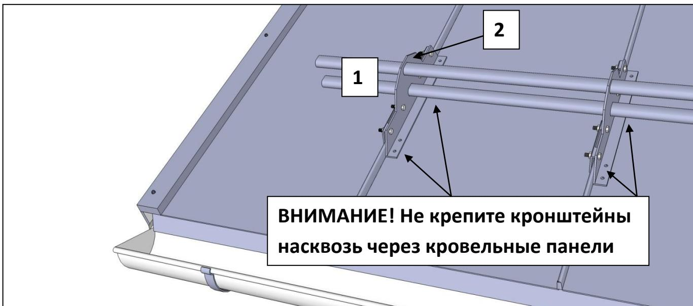
Подробнее – в Стандарте УНИКМА Строительство скатной кровельной системы
