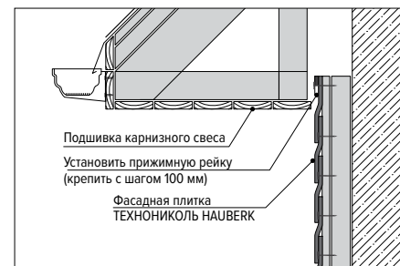
Рис. 9.1. Монтаж верхнего ряда под карнизным свесом
