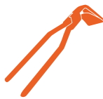
Кровельные клещи (хапы) прямые и под 45°, шириной 60 мм
