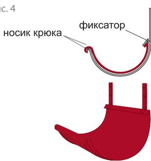
Вставьте желоб в крюк. Для этого заведите носик крюка в желоб так, чтобы носик крюка оказался внутри завитка желоба, затем зафиксируйте другой край желоба накладным пластинчатым фиксатором (рис. 4). При этом внешний край желоба ниже внутреннего на 6 мм в целях предотвращения попадания воды на фасад во время сильных ливней.
