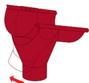
Разметьте предполагаемые места установки воронок и вырежьте в желобе с помощью ножовки либо ножниц по металлу V-образное отверстие шириной 100-110 мм.
